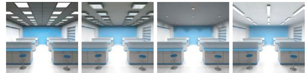
La distribuzione omogenea della luminosità in uno spazio è influenzata dalla scelta degli apparecchi illuminanti. Apparecchi con distribuzione diretta del flusso luminoso (Figura 1-3) non garantiscono un sufficiente illuminamento delle superfici verticali, causando l'effetto caverna. Ciò può essere evitato utilizzando apparecchi con una curva di luminosità molto ampia. (Fig. 4).
