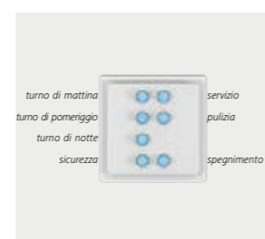
Descrizione dei pulsanti sul pannello di controllo per la gestione degli scenari di illuminazione
